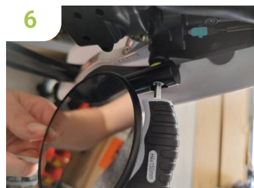
Spiegel von unten montieren und mit einem H4 Schlüssel behutsam anziehen, Spiegel einstellen und Kontermutter festziehen (17mm)
