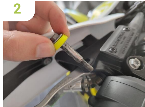
Passschraube herausziehen und das mitgelieferte Distanzstück aufstecken (hier Gelb)
