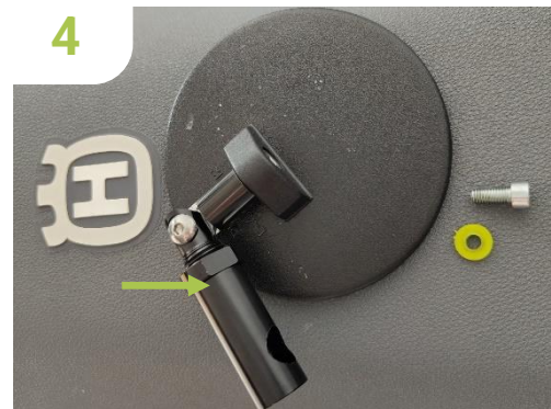
motex Spiegeladapter mit originaler Spiegelschraube wie abgebildet montieren
