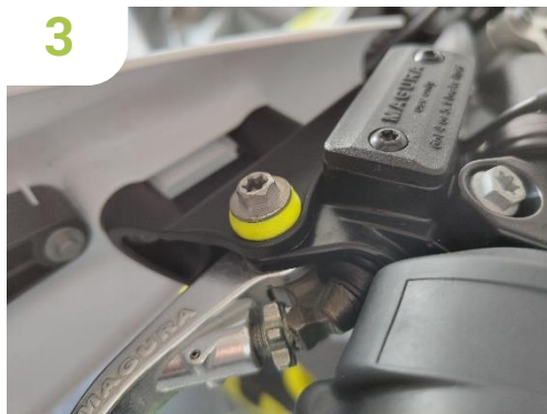
Passschraube wieder einschrauben und festziehen
