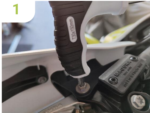
Handhebel-Passschraube mit einem TX30 Schlüssel lösen
